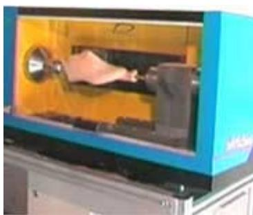
La machine-outil, 3 axes, MiniLast® (Y, Z, B) a spécialement été conçue par IDEAS pour une production rapide et chez soi de formes dans toutes sortes de matériaux (plastiques durs, PE, PU, Epoxy, Bois, ...)
